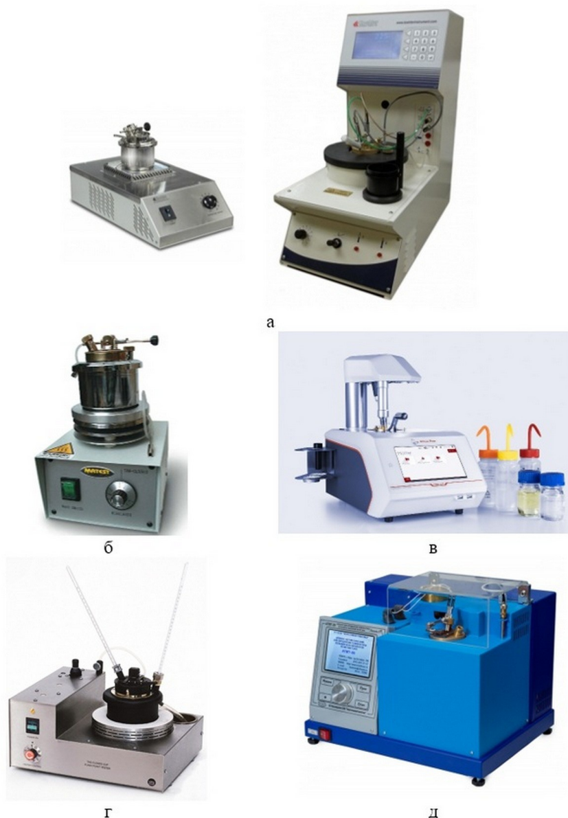
Рисунок 5 - Современные закрытые приборы Тага
